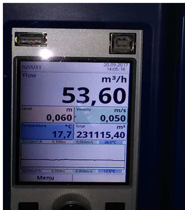
Exemplo do display do caudalímetro montado na ribeira de Aldoar
