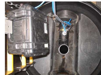
Medição de caudal numa tubagem permanentemente cheia (NPP) com PCM Pro
